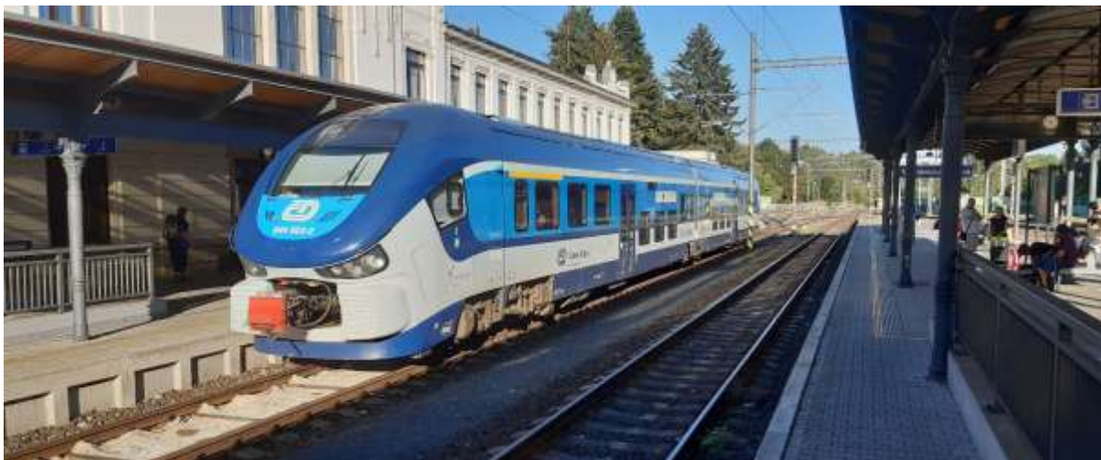
Obrázek 34 – dieselová jednotka Pesa Link v Mariánských Lázních. Na trati Tábor – Ražice budou od roku 2023 nasazována podobná vozidla od téhož výrobce a nabídnou dostatečný komfort na důležité vnitrokrasné lince
